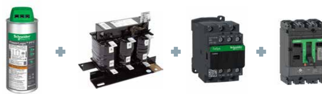
พิกัดแรงดันในระบบที่ 400 V AC, 50Hz พิกัดแรงดันคาร์ปาซิเตอร์ที่ 480 V AC 5.7%, 7% Detuned Filter
